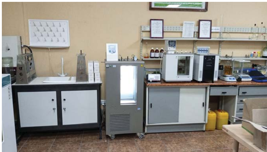
1-rasm Kinematik qovushqoqlik birligi milliy boshlang'ich etaloni (O'z MBET 24:2024)
