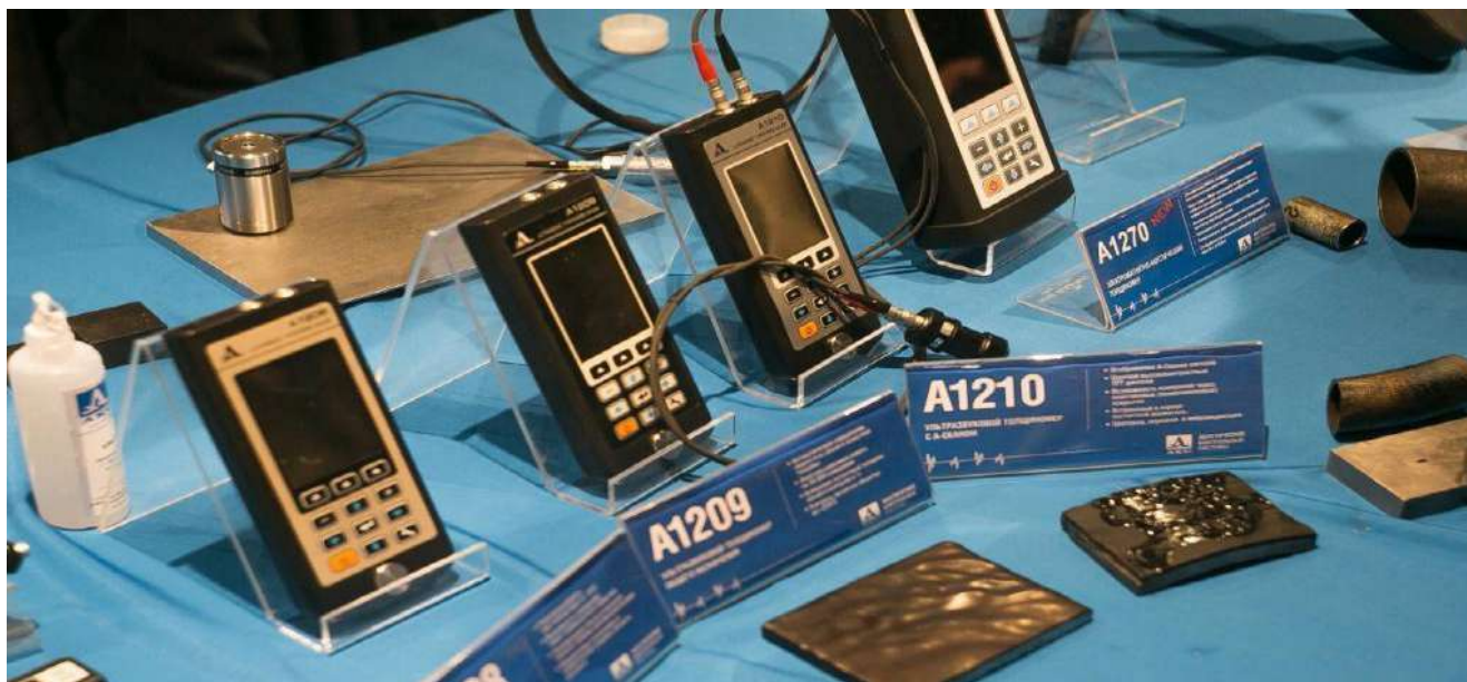
1-rasm. Ultratovushli qalinlik o'lchagichlar
