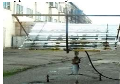
2-расм. Ясси чизикли Френел кўзгулари асосидаги куёш концентраторини тажрибавий қурилмаси.
