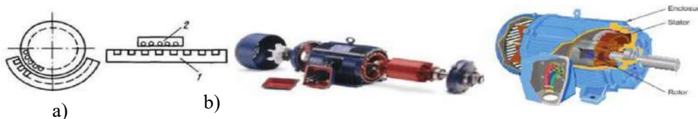
2- rasm. Modifikatsiyalangan elektr mashinalarining konstruktiv bajarilishi: a) – segment statorli mashina; b) – chiziqli dvigatel va uch fazali (AC) zgaruvchan tok induksion motori kesimi.
