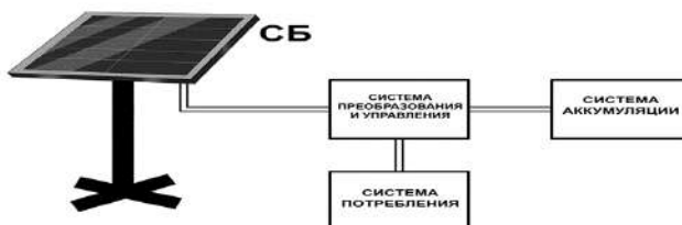
Рисунок. Общая схема преобразования солнечной энергии в электрическую.
