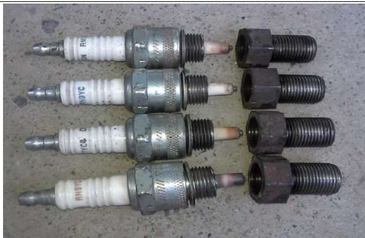
2- расм. Лаваль соплоси билан жиҳозланган свеча
