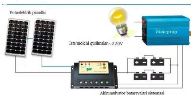
1-rasm. Fotoelektrik tizimining ulanish sxemasi.
