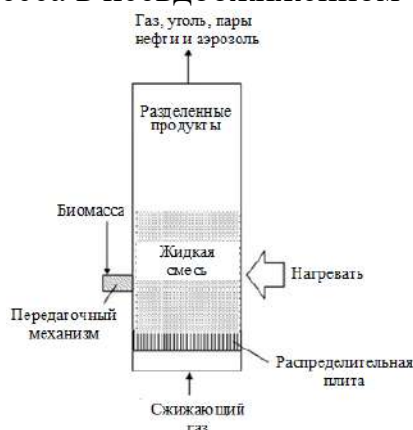
Рисунок 2. Принципиальная схема процесса пузырьющегося абстрактного псевдооживленного слоя.
