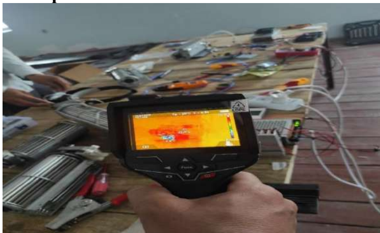
1-расм. Тепловизор қурилмаси ёрдамида пелтиер ҳароратини ўлчаниши
