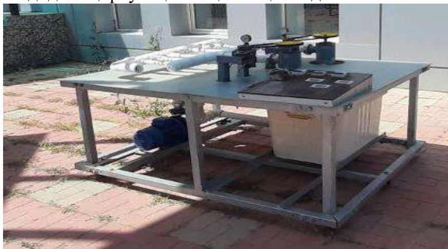
2-расм. Пико гидротурбина моделларини тажриба-синовдан ўтказиш учун тайёрланган стенд
