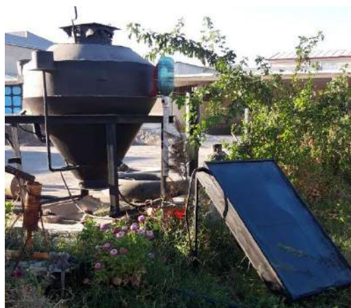
Расм 2. Қуёш коллекторли кичик ҳажмли тажриба ишлаб чиқариш қурилмаси.
