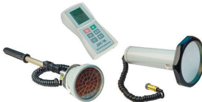
Рис.1. Дозиметр – радиометр ДКС – 96 и блоки детектирования: а) БДЗБ -99, б) БДЗА – 96
