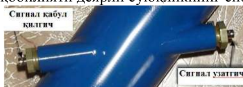
4-расм. Ультратовуш сарф ўлчагичининг сигнални қабул қилгич ва узатгичи.
