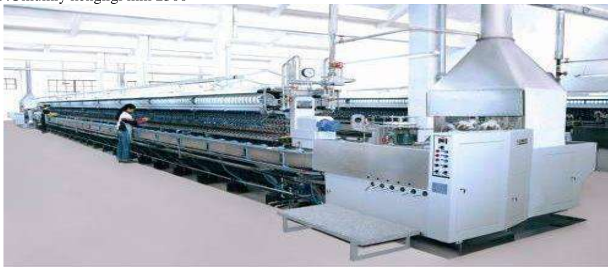
1-rasm. FY-2008 pilla chuvish avtomatining umumiy ko'rinishi
