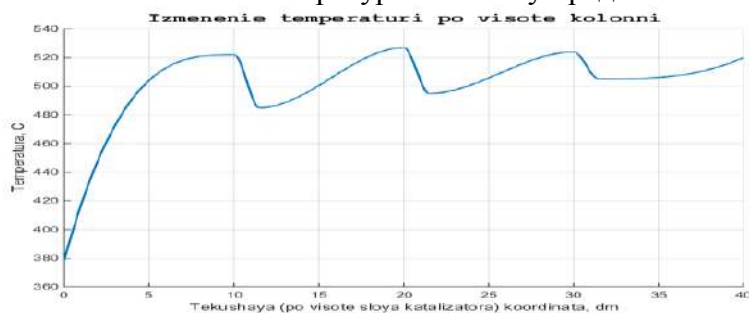
Рисунок 1 – Распределение температуры по высоте катализаторного слоя четырехполочной колонны синтеза.
