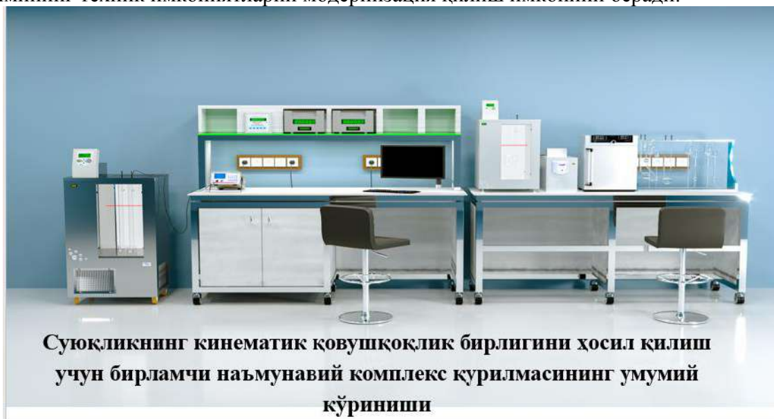
2-расм. Кинематик қовушқоқликни бирламчи эталонини моделлаштирилган умумий кўриниши
