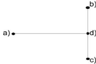
2-расм. Электр схемасининг дарахт кўриниши
