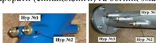
5-расм. Бир нечта каналга уланиш учун мўлжалланган ультратовуш сарф ўлчагич.
